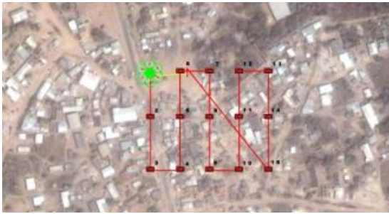
Plan de vuelo de Aibot X6 con 15 waypoints.
